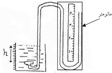
$h_2$ ,  $h_1$  بترتیب فاصله طبلک تا سطح آزاد مایع و  $H_1$ ,  $H_2$  اختلاف ارتفاع سطح مایع، نظیر آنها در لوله U شکل مانومتر برای دو حالت مختلف فوق باشد
