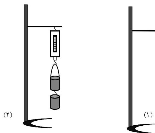
مطابق شکل (۲) استوانه تو پر را به قلاب زیر استوانه تو خالی متصل کرده و مجموعه را به نیرو سنج متصل نمایید (استوانه تو خالی و تو پر هم حجم هستند)، پس از رسیدن به حالت تعادل بدقت عدد نیرو سنج را خوانده و
