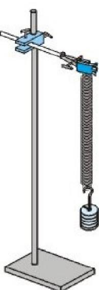
از رابطه فوق با معلوم بودن جرم وزنه آویزان شده و افزایش طول فنر می توان ضریب ثابت فنر را تعیین کرد.
